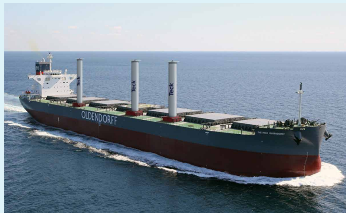
En la fotografía: Representación de la embarcación de Oldendorff equipada con un sistema de rotores Flettner.
